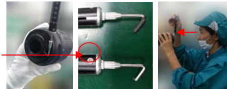
รูปที่ 8 เสรียมยางหุ้มปลาย Tension gage และกำหนดระดับสายตาที่ถูกต้องในการอ่านค่า
