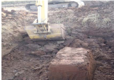
รูปที่ 4 เปิดหน้าดินและรอบตัวอย่างดิน
