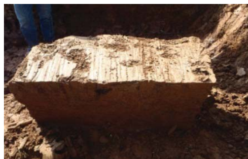
รูปที่ 5 การตกแต่งผิวให้เรียบและได้ขนาดเท่ากับกล่องบรรจุตัวอย่าง
