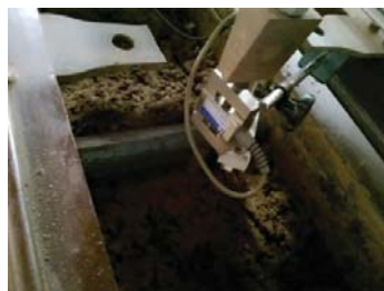
รูปที่ 9 การพลิกคว่ำของแบบจำลองฐานรากเข็มพืด ก่อนที่ดินจะเกิดการวิบัติ จากการทดสอบที่ 0.0BE0.3
