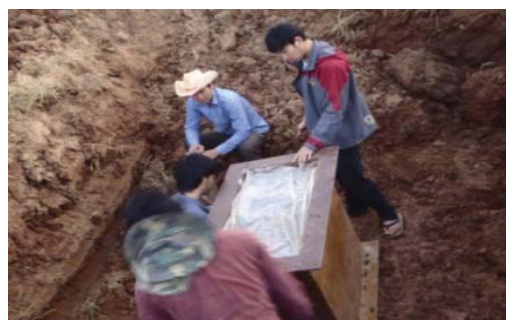
รูปที่ 6 หุ้มด้วยพลาสติกและบรรจุดินใส่กล่องตัวอย่าง
