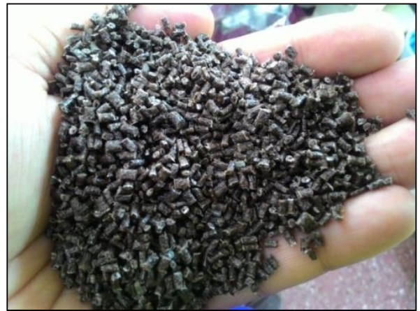
รูปที่ 3 พอลิโพรพิลีนกับผงกากกาแฟที่ได้จากการผสมด้วยเครื่องอัดรีดสกรูคู่
