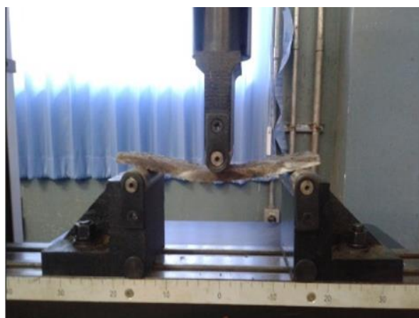
รูปที่ 3 การทดสอบคุณสมบัติด้านทานแรงดัด
