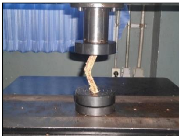
รูปที่ 2 การทดสอบคุณสมบัติด้านทานแรงอัด
