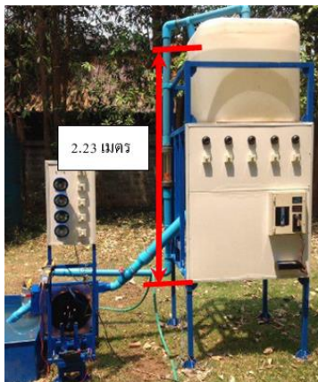
รูปที่ 1 กังหันน้ำขนาดเล็กผลิตไฟฟ้าที่ทำงานวิจัย
