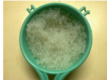
รูปที่ 1 ลักษณะเซลล์ดักติดด้วยสารแบเรียมแอลจินेट
