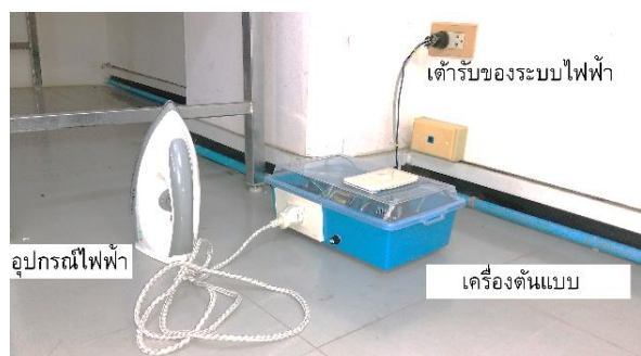
รูปที่ 16 การต่อเครื่องใช้ไฟฟ้ากับเครื่องต้นแบบ
