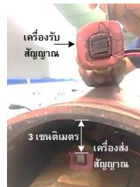
ก) การติดตั้งเครื่องส่งสัญญาณในท่อและเครื่องรับสัญญาณนอกท่อ
