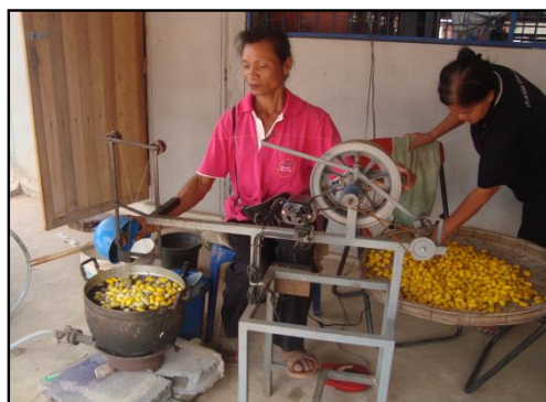
รูปที่ 3 การสาวไหมแบบมือหมุน
