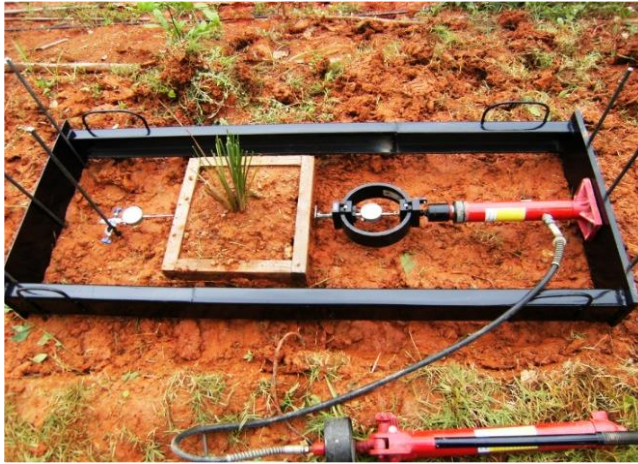
(ก) การติดตั้งชุดทดสอบแรงเค้นตรงในสนาม
