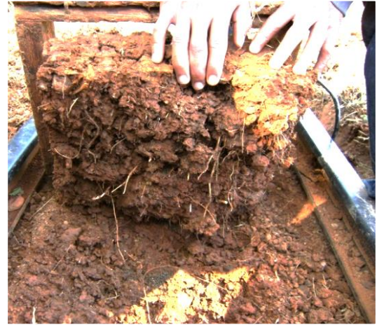
(ข) สภาพการพิบัติของตัวอย่างดินและรากหญ้าอายุ 2 เดือน
