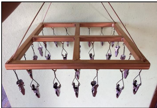
รูปที่ 4 อุปกรณ์ช่วยในการจุ่มไส้เทียน 1
