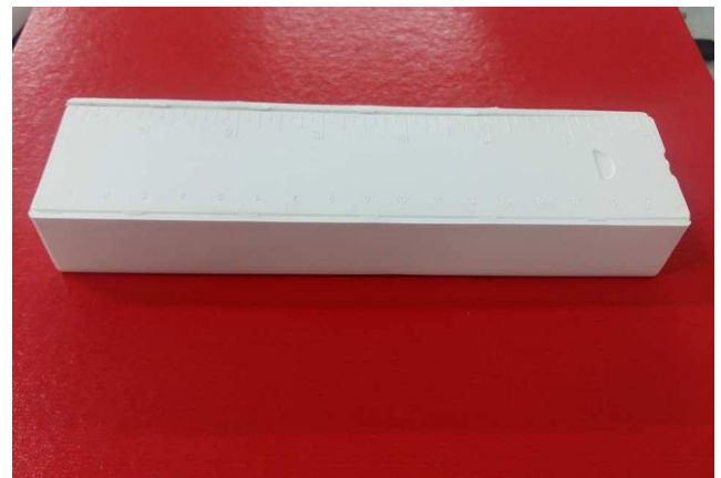
รูปที่ 17 กล่องดินสอด่ที่ผลิตจากพอลิออกซีเมทิลีนรีไซเคิลสูตร r-POM/5/0
