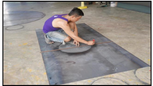
รูปที่ 6 การวัดขนาดขอบช่อง
