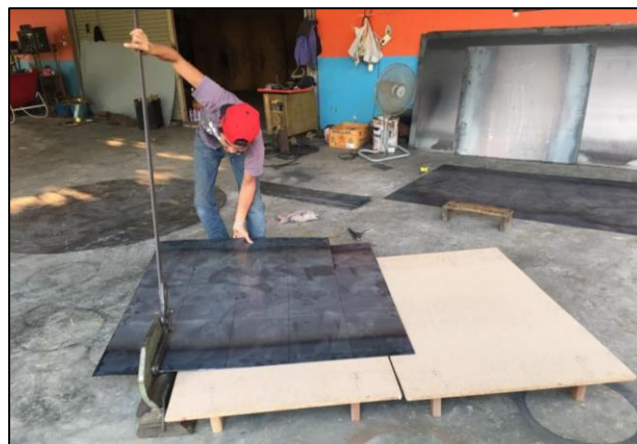
รูปที่ 12 การตัดแผ่นเหล็กส่วนขอบข้อด้วยโต๊ะรองรับน้ำหนัก
