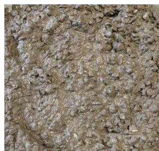
รูปที่ 1 ลักษณะการจับตัวของคอนกรีตผสมยางพาราและเถ้าหนักลิกไนต์
