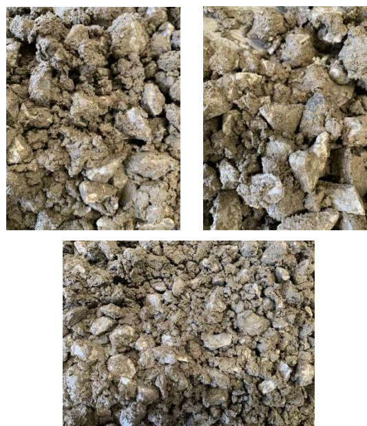
รูปที่ 1 ลักษณะการจับตัวของคอนกรีตผสมยางพาราและเถ้าหนักลิกไนต์
