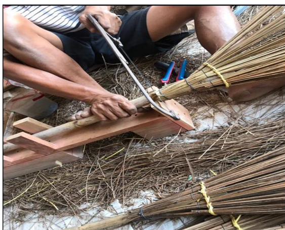
รูปที่ 14 การเลื่อยโคนไม้กวาดด้วยอุปกรณ์จับยึด
