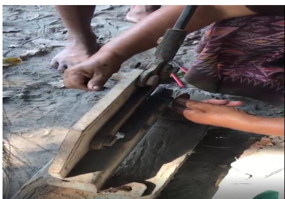
รูปที่ 9 การตัดลวด
