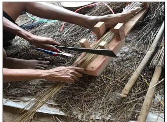
รูปที่ 13 การแยกทางมะพร้าวด้วยอุปกรณ์จับยึด
