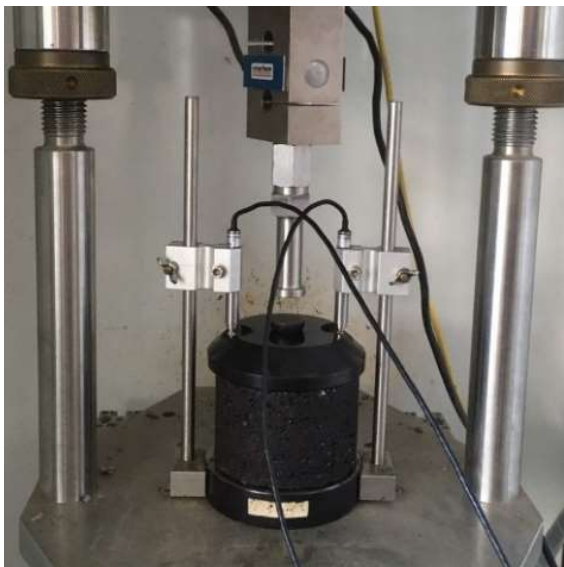
รูปที่ 5 ลักษณะการติดตั้งตัวอย่างการที่ใช้ทดสอบในงานวิจัย
