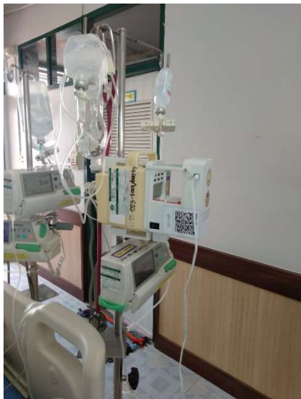
รูปที่ 14 การติดตั้งอุปกรณ์เสริมควบคุมระยะไกลเข้ากับเครื่องควบคุมการให้สารละลายทางหลอดเลือดดำ ณ โรงพยาบาลมหาสารคาม
