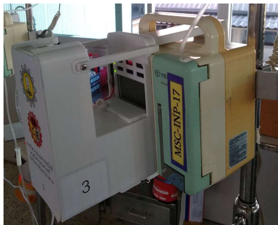
รูปที่ 10 การติดตั้งอุปกรณ์เสริมควบคุมระยะไกลเข้ากับเครื่องควบคุมการให้สารละลายทางหลอดเลือดดำ
