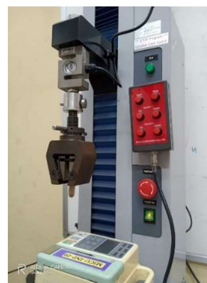
รูปที่ 11 การติดตั้งเครื่อง Universal Testing Machine เพื่อทดสอบแรงกด
