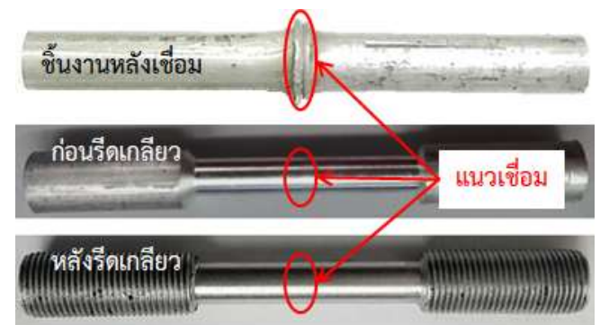
รูปที่ 3 ชิ้นงานทดสอบแรงดึงตามมาตรฐาน
