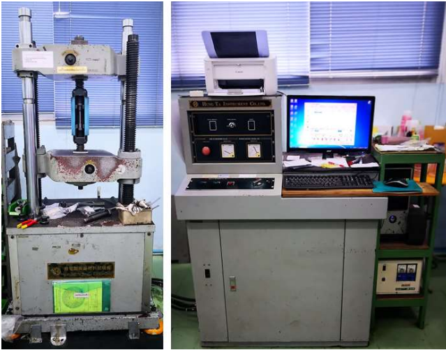
รูปที่ 4 เครื่องทดสอบเนกประสงค์ และอุปกรณ์สำหรับบันทึกผล
