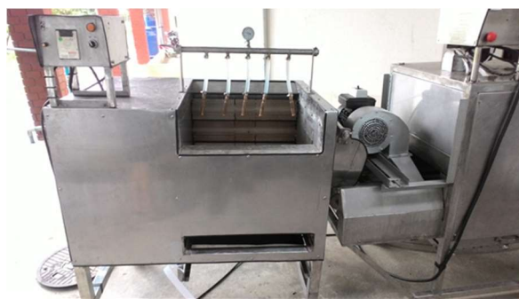
รูปที่ 2 เครื่องล้างหัวมันเทศโดยใช้แรงดันน้ำ
