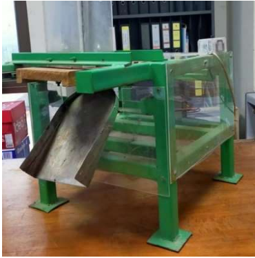
รูปที่ 2 เครื่องสไลด์มันฝรั่งขนาดเล็กแบบแกนนอนสำหรับงานวิจัย
