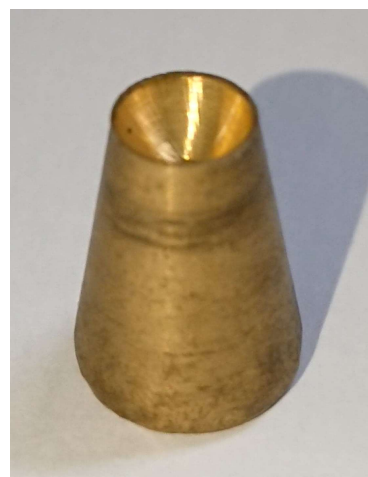
รูปที่ 8 วาล์วทรงกรวยในทอว์อร์ทกซ์ที่ระยะโค้งเว้า 3 มิลลิเมตร
