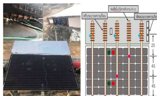
รูปที่ 7 การติดตั้งท่อความร้อนโดยใช้สาร R-11 เป็นสารทำงาน ในชุดทดสอบแผงเซลล์แสงอาทิตย์
