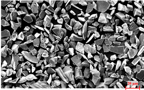
รูปที่ 1 ลักษณะของซิลิคอนคาร์ไบด์ที่ได้จากการตรวจสอบด้วยกล้องจุลทรรศน์แบบส่องกราด (SEM)
