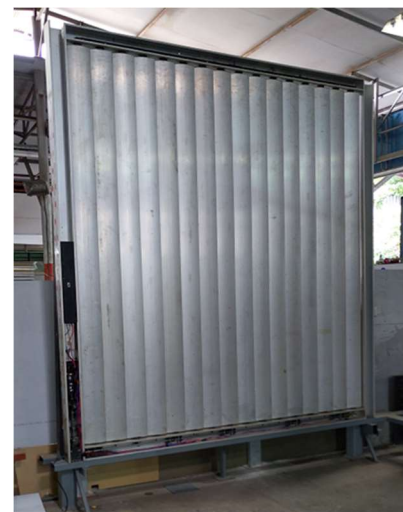
รูปที่ 8 ผนังบานเกล็ดอลูมิเนียมชนิดใบวงรี แบบแนวตั้งของบริษัท เอ็ม.วี.พี. โพรสตาโรส
