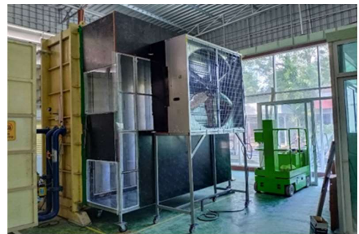
รูปที่ 11 การติดตั้งผนังบานเกล็ดกับห้องสร้างความดัน (Chamber)
