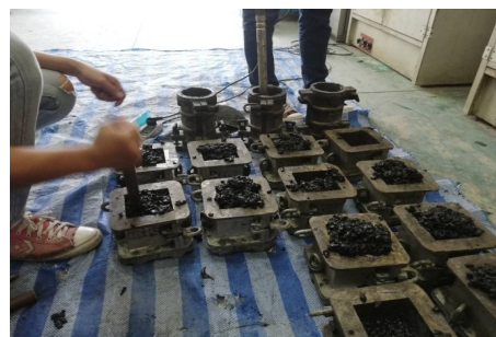
ก) ใส่จีโอโพลิเมอร์คอนกรีตลงในแบบหล่อคอนกรีต
