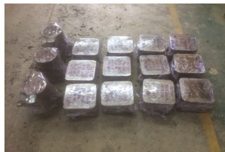
ข) นำพลาสติกใส (Plastic film) พันรอบแบบหล่อ
