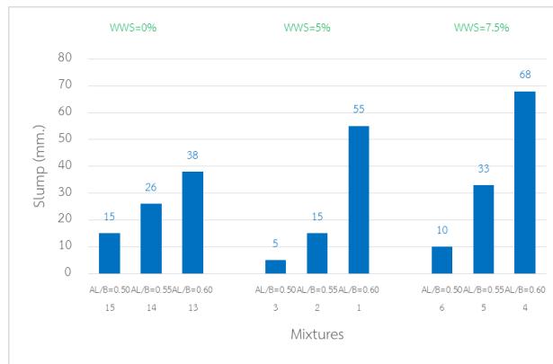
รูปที่ 9 การทดสอบหาค่ายุบตัวของจีโอโพลิเมอร์คอนกรีต (ผสมหินปูนย่อย)
