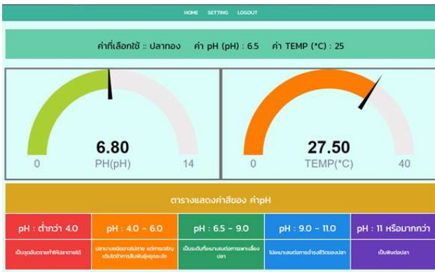
รูปที่ 2 การออกแบบเว็บแอปพลิเคชันเพื่อควบคุมและแสดงผลโดยเชื่อมต่อกับระบบปรับปรุงคุณภาพน้ำสำหรับตู้ปลาสวยงาม
