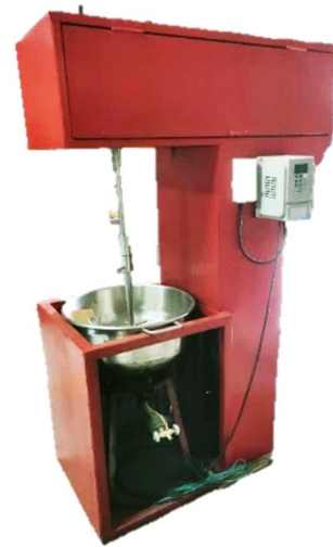
รูปที่ 5 เครื่องกวนจันทน์เทศที่ได้จากการออกแบบ
