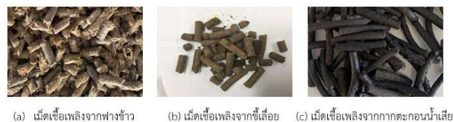
รูปที่ 4 การอัดขึ้นรูปเม็ดเชื้อเพลิงจากวัตถุดิบชนิดต่างๆ
