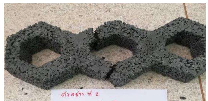
รูปที่ 9 การวิบัติของคอนกรีตในการทดสอบแรงดัด
