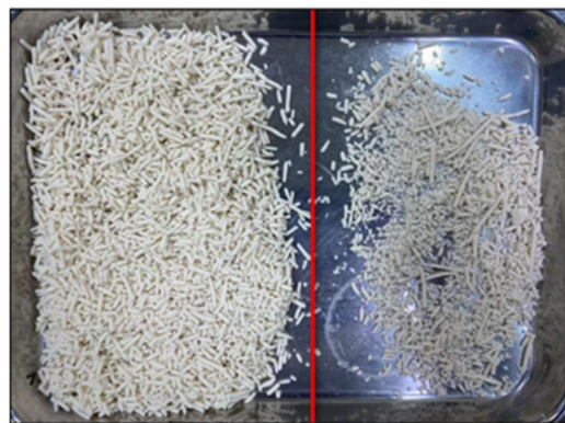
(1) ลักษณะเม็ดข้าวบุงที่ใช้ใบมีดตัดโค้งหน้าตัดขึ้นรูป
