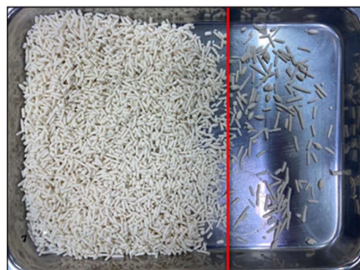
(2) ลักษณะเม็ดข้าวบุงที่ใช้ใบมีดตัดโค้งหลังตัดขึ้นรูป
