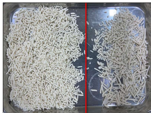
(ลักษณะเม็ดข้าวบุงที่ใช้ใบมีดตัดตรงตัดขึ้นรูป (3)
