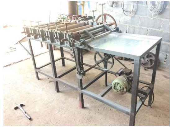
รูปที่ 5 เครื่องรีดยางพาราแผ่นเรียบที่พัฒนาขึ้น (จริง)
