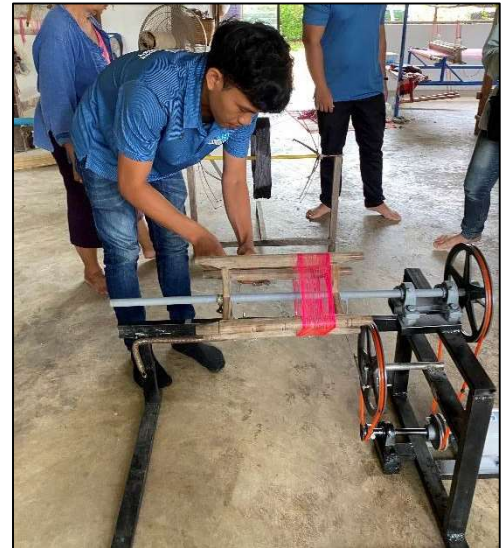
รูปที่ 15 การกักไหมด้วยเครื่องกักไหมที่ออกแบบใหม่
