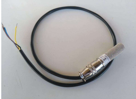
รูปที่ 9 เซ็นเซอร์วัดความชื้นในดิน SHT10
