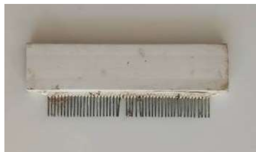
รูปที่ 4 อุปกรณ์การแยกเส้นใยกล้วยน้ำว้า
