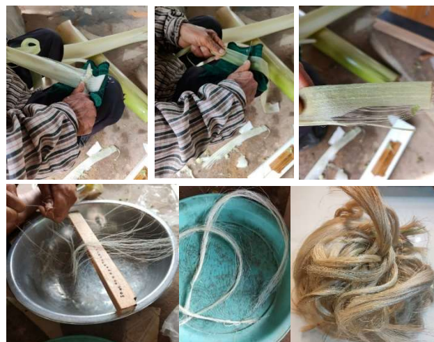
รูปที่ 6 การแยกกาบกล้วยน้ำว้าเป็นเส้นใยเดี่ยว
