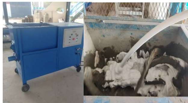
รูปที่ 8 การผสมวัสดุในเครื่องผสมคอนกรีตมวลเบา 2 in 1
