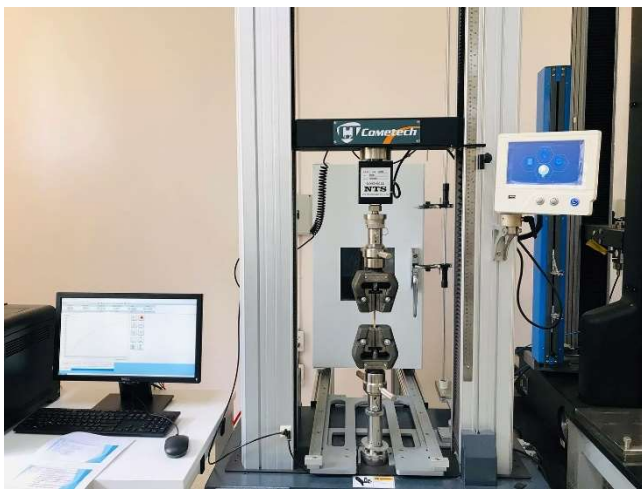
รูปที่ 7 เครื่องทดสอบสากลยี่ห้อ Comtech รุ่น QC-506M2F
