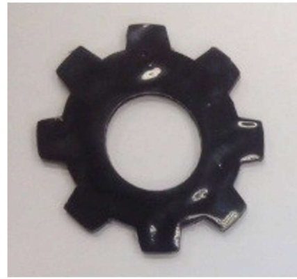
รูปที่ 12 ชิ้นงานตัวอย่างที่ขึ้นรูปด้วยกระบวนการอัดร้อน (rPP-ตะกร้า+RHA 29 \mu\text{m} ที่เติมเส้นผ่าศูนย์กลาง 7 phr)
