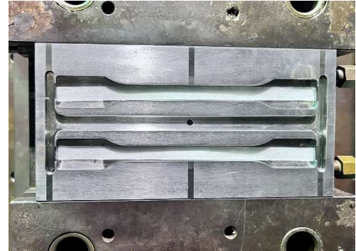
ก) วางผ้าไม่ถักไม่ทอลงในแม่พิมพ์ (Cavity)
