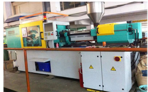
ข) เครื่องฉีดขึ้นรูป (Injection Molding, ARBURG 470C)
