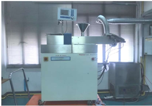
รูปที่ 1 เครื่องขึ้นรูปผ้าไม่ถักไม่ทอ (Thermo HAAKE® PolyDrive (Single Screw Extruder))
