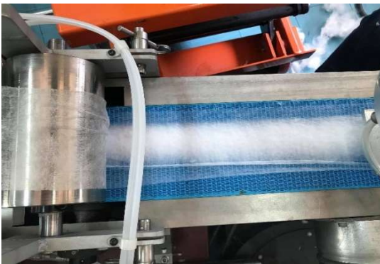
ก) สายพานรองรับเส้นใยที่ถูกพ่นผ่านด้วยแรงดัน
