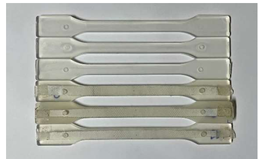
ค) ตัวอย่างชิ้นงานคิมเบลทั้งแบบแทรก และไม่แทรกผ้าไม่ถักไม่ทอ
