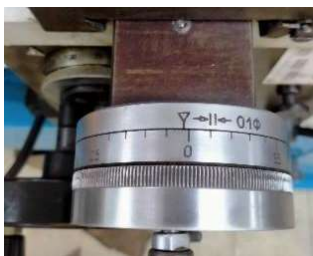
รูปที่ 5 การเปลี่ยนชุดสเกลป้อนกินลึกเครื่องกลึง
