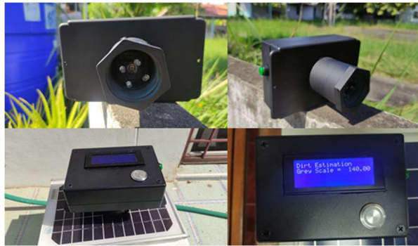
รูปที่ 4 เครื่องวัดค่าความสกปรกของแผงเซลล์แสงอาทิตย์ด้วยโมดูลแยกสี TCS3200
