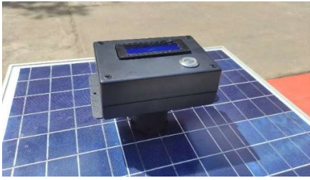
รูปที่ 7 ขณะทำการวัดค่าระดับสีเทาของพื้นผิวแผงเซลล์แสงอาทิตย์
