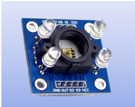
รูปที่ 1 โมดูลอ่านค่าสี TCS3200: COLOR LIGHT-TO-FREQUENCY CONVERTER
