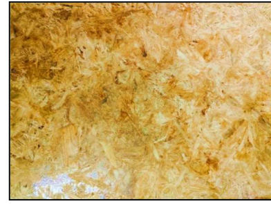
รูปที่ 6 แผ่นไม้ไผ่จากเศษไม้ไผ่ ที่อุณหภูมิอัดร้อน 210 °C เวลาอัดขึ้นรูป 15 min
