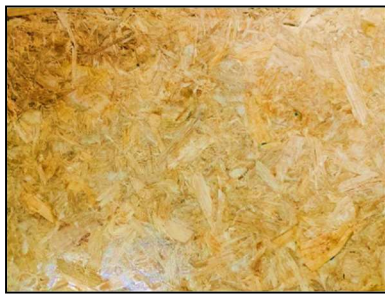
รูปที่ 5 แผ่นไม้ไผ่จากเศษไม้ไผ่ ที่อุณหภูมิอัดร้อน 190 °C เวลาอัดขึ้นรูป 15 min
