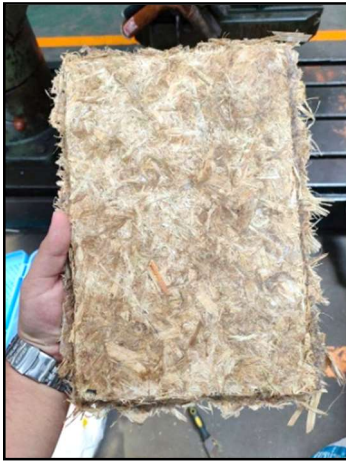
รูปที่ 2 แผ่นไม้ไผ่จากเศษไม้ไผ่ที่ได้จากการอัดขึ้นรูปร้อน
