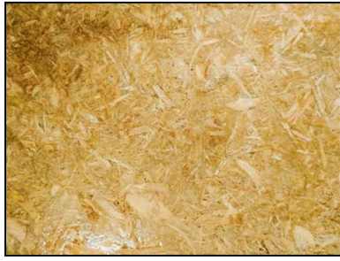
รูปที่ 4 แผ่นไม้ไผ่จากเศษไม้ไผ่ ที่อุณหภูมิอัดร้อน 170 °C เวลาอัดขึ้นรูป 15 min
