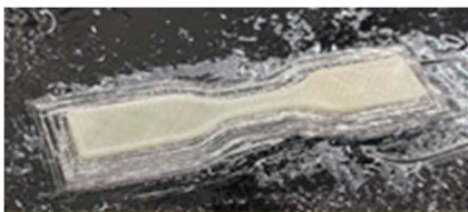
รูปที่ 3 ลักษณะชิ้นงานทดสอบแรงดึงใช้เพื่อสร้างชิ้นงาน 3 มิติ
