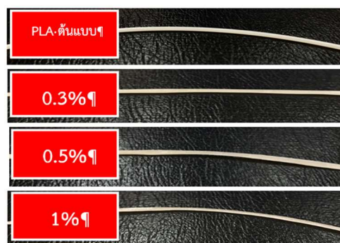
รูปที่ 2 ลักษณะเส้นพลาสติกใช้สำหรับการพิมพ์ขึ้นรูป 3 มิติ
