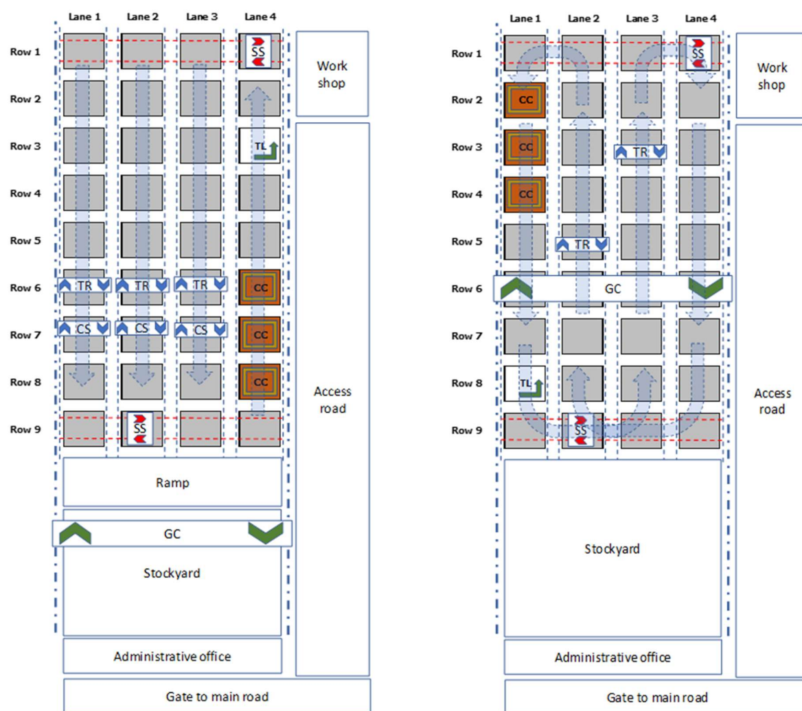
รูปที่ 5 ผังบริเวณของวิธีแบบหล่อหมุนเวียนพร้อมกันหลายเลน (MLCP) และวิธีแบบหล่อหมุนเวียนเส้นเดียว (SLCP)
