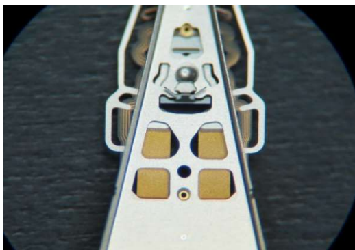
รูปที่ 13 แผ่นเพียโซอิเล็กทริกหลังการประกอบด้วยแรงกด 11 นิวตัน
