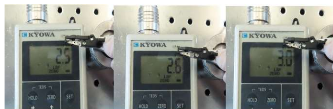
รูปที่ 7 การวัดแรงกดของพนักงานด้วยเครื่องชั่งดิจิทัล
