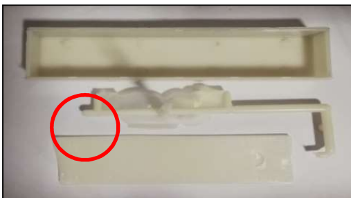
รูปที่ 9 ชิ้นงานจริงที่ฉีดไม่เต็ม
