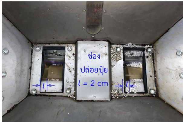
รูปที่ 6 The 2 cm length ( l ) of fertilizer discharge channel in a fertilizer hopper.
