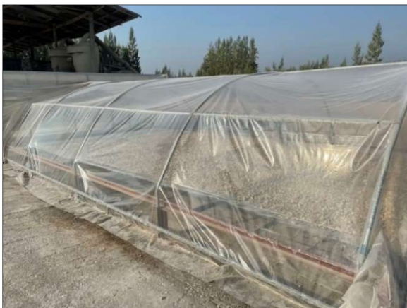
รูปที่ 1 อุโมงค์อบแห้งพลังงานแสงอาทิตย์ขณะกำลังอบแห้ง
