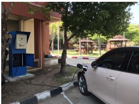
รูปที่ 9 การทดสอบเครื่องอัดประจุกับยานยนต์ไฟฟ้าที่ถ่ายจากภาพจริง
