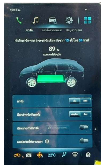
รูปที่ 24 ระยะเวลาการอัดประจุที่กระแส 32 A เวลา 10.15 น. บนหน้าจอยานยนต์ไฟฟ้า
