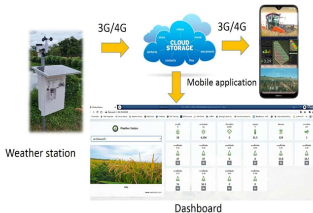
รูปที่ 3 การทำงานของสถานีตรวจวัด สภาพอากาศ
