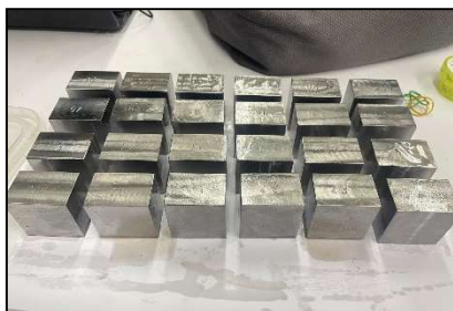
1) ชิ้นงานเหล็กกล้าเครื่องมือ JSI SKD61 ขนาด 39X40x26 มิลลิเมตร
