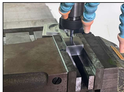
5) การกัดชิ้นงานจริง ตามตารางสุมการทดลอง จนครบ 24 การทดลอง
