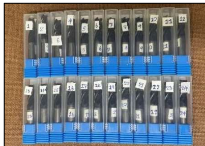
2) ดอกเอ็นมิลคาร์ไบด์ ๘ มิลลิเมตร 4 คมตัด เคลือบสาร TiAlN
