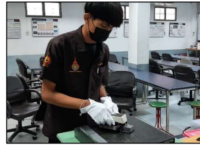
6) วัดค่าความเรียบผิวชิ้นงาน 24 ชิ้น แล้วนำบันทึกผลการทดลอง
