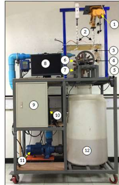
รูปที่ 13 ฮาร์ดแวร์ของชุดวัดแรงบิดที่สร้างขึ้น
